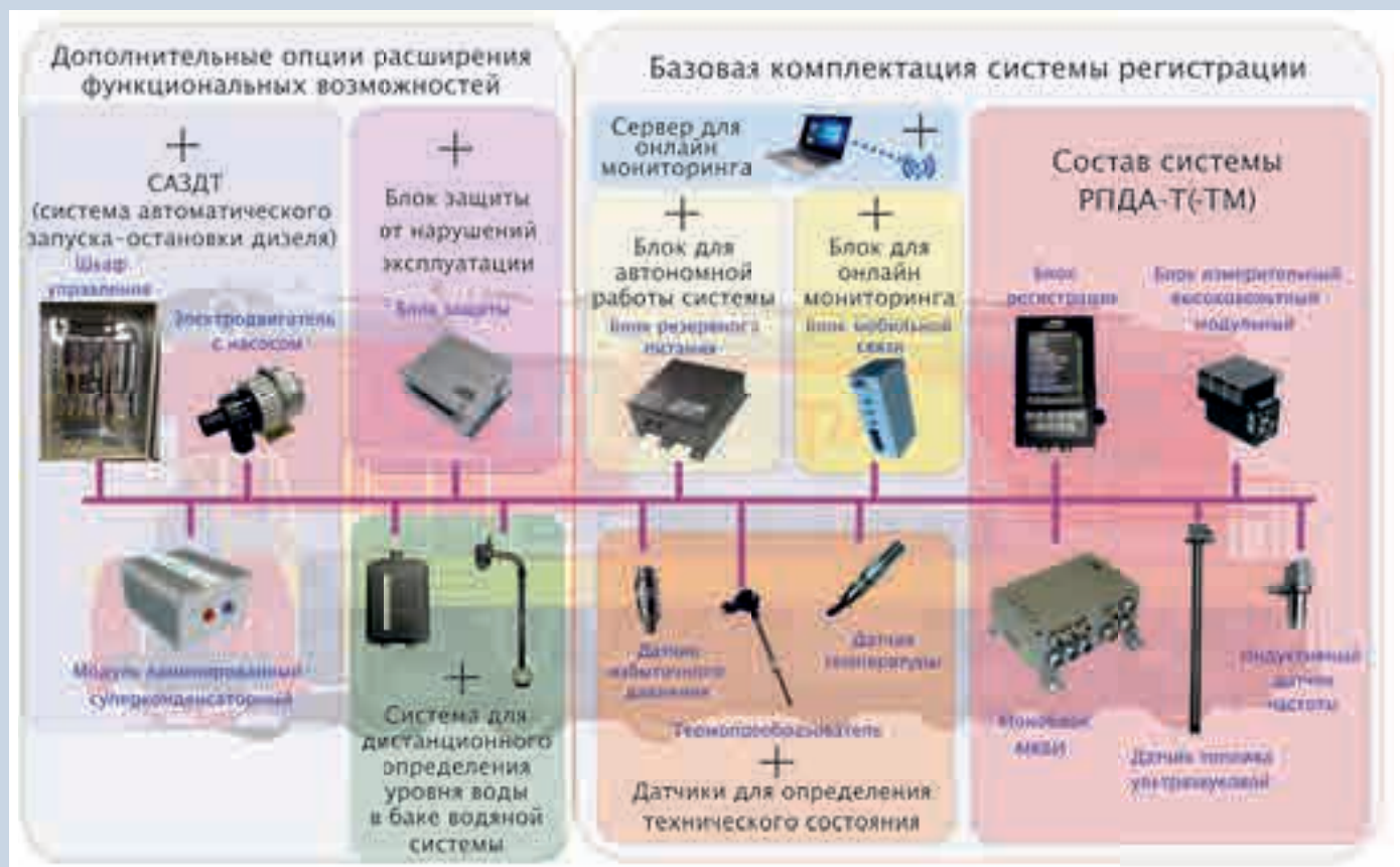
Комплексная автоматизированная система регистрации движения, параметров работы, контроля наличия и расхода дизельного топлива РПДА-Т(-ТМ) с дополнительными функциями самопрогрева и технической диагностики для тепловозов
