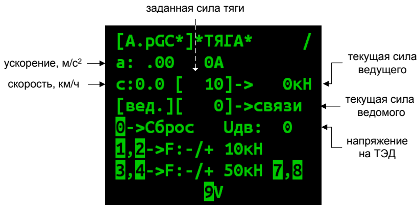
Рисунок 6. Экран управления тягой заданием силы в режиме кнопочного контроллера.
