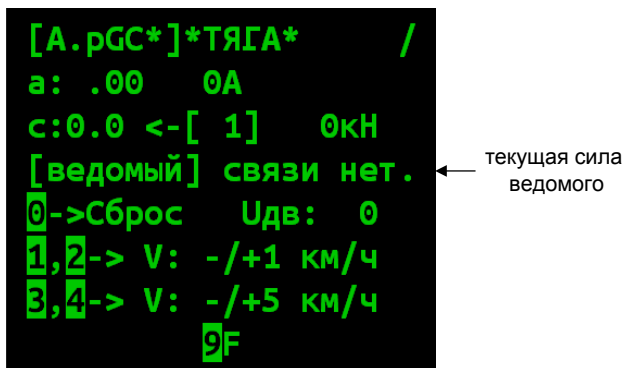
Рисунок 6а. Экран управления тягой заданием скорости в режиме кнопочного контроллера.
