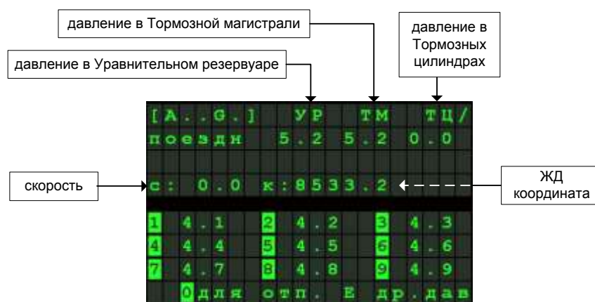
Рисунок 27 – Пример отображения экрана управления автотормозами в режиме кнопочного контроллера
