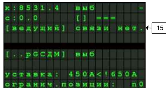
Рисунок 10 – Рабочий экран ИСАВП-РТ в режиме ведомого электровоза
