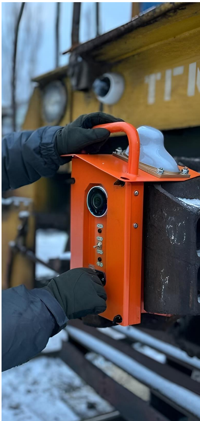
Рис. Установка блока МБВ в зев автосцепки СА-3
